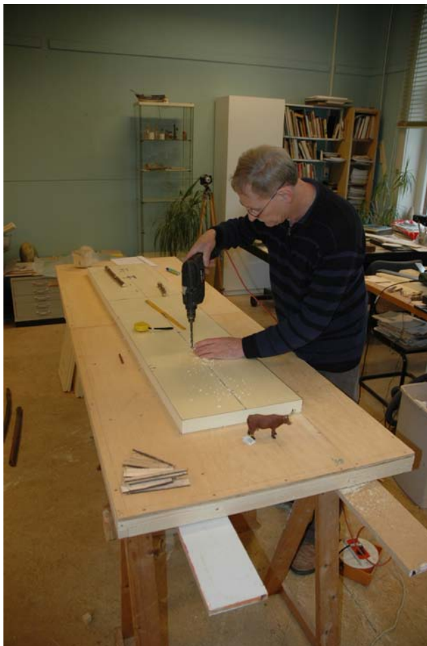
Afb. 15.10 Grondplaat en een koetje op schaal. Jelus boort gaten op de plaats van de middenstaanders.
